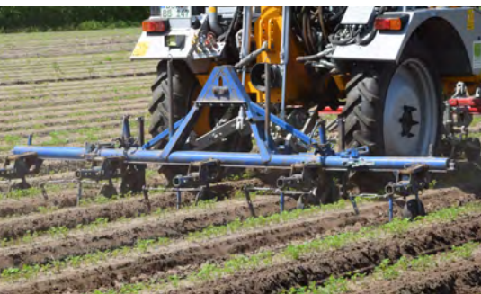
Diese Hackmaschinen fahren über die Möhrenfelder, hacken dabei die Erde auf und beseitigen damit das Unkraut.
